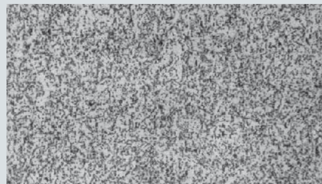
Gefüge nach dem Weichglühen – VMR (VLBO)-Qualität / Microstructure after soft annealing – VMR (VAR) quality
