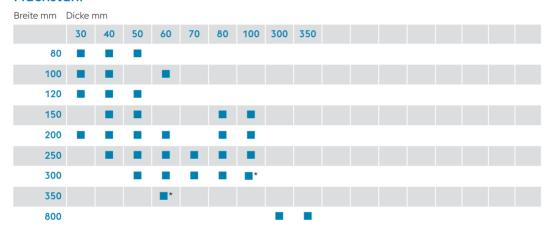
Gewalzt nach DIN EN 10058 bzw. geschmiedet nach DIN 7527/T6, Oberfläche sandgestrahlt, \*zwei Schmalseiten bearbeitet.
