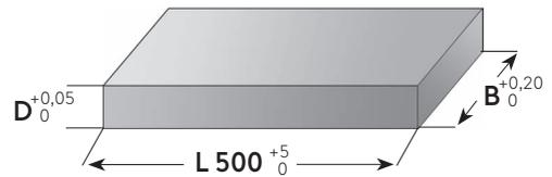
**Präzisionsflachstahl mit Bearbeitungsaufmaß**
